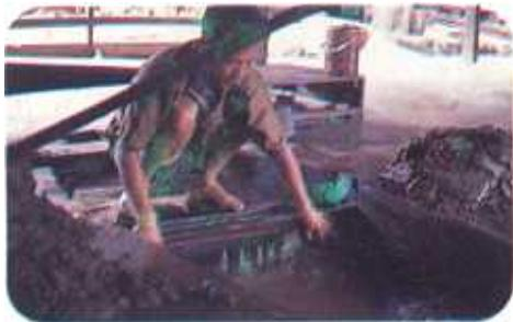
**9.4 ลักษณะโครงสร้าง :** เมื่อตั้งถอนของแร่ดินบุกที่มีขนาด ละเอียดมากก็จะมีการแยกแร่ดินบุกให้ละเอียดขึ้นด้วย โดยการคัดตะกอนดินทรายออกด้วยคนแต่งแร่
