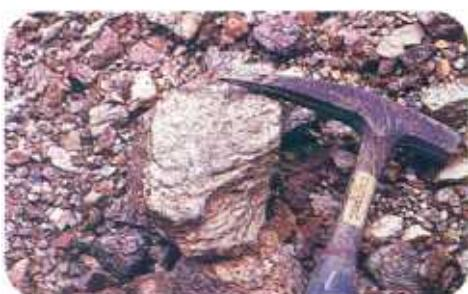
7.2 ลักษณะโครงสร้าง : เป็นหินฟิลไลต์อันเกิดจากการแปรสภาพมีสีน้ำตาลอ่อน เนื้อหิน เป็นมันลื่น มีการเรียงตัวเป็นชั้น ๆ ลอกเป็นแผ่นได้ง่าย
