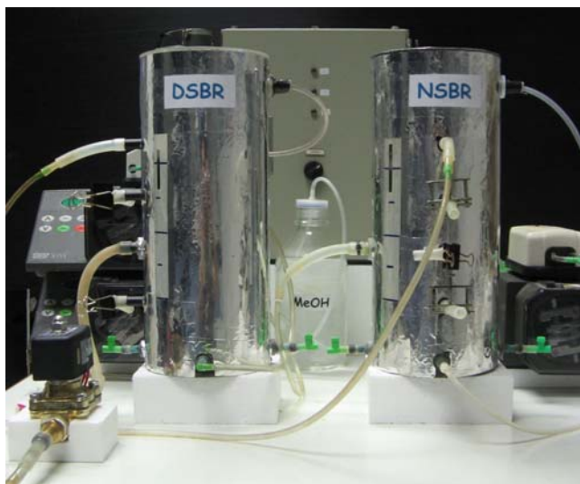
ภาพที่ 9 ระบบเอสบีอาร์แบบสองขั้นตอนที่ใช้ในการศึกษา
